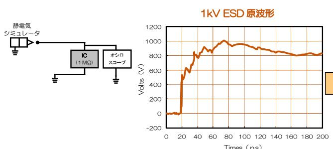
KVA 型はIC等の被保護素子と並立に、そしてGND間に挿入することで、被保護素子にかかるESDを抑制し、誤差動や破壊を防ぎます。
