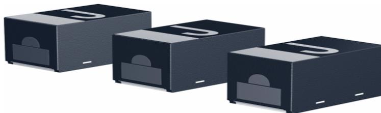
携帯電話、スマートフォンなどの携帯型情報通信機器や、デジタルビデオカメラ、デジタルスチルカメラ、携帯オーディオなどの携帯型AV機器に数多く使用されております、下面電極タイプ251型の低背品を開発しました。
