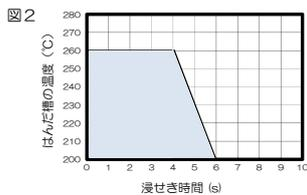
浸せき時間が図2以上の条件になる場合、部品の温度上昇を抑えるため、リード線にスペーサーを取り付け、基板から一定量浮かせる方法を採用してください。その場合ははんだ槽の温度と浸せき時間の許容範囲を図3に示します。
