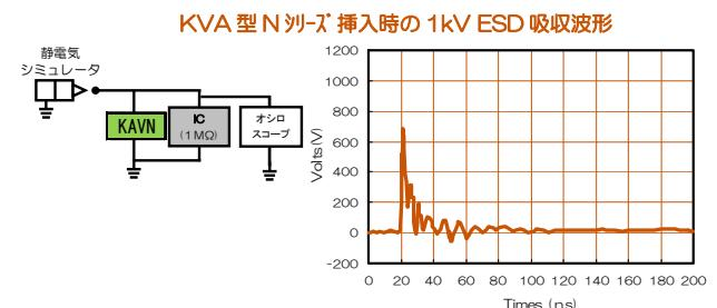
KVA型 N シリーズは IC 等の被保護素子と並立に、そして GND 間に挿入することで、被保護素子にかかる ESD を抑制し、誤差動や破壊を防ぎます。
