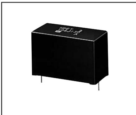
559型は、CDI回路用として開発されたケース入りメタライズドポリエチレンテレフタレートフィルムコンデンサで、充放電に対してすぐれた耐久性を持っています。
